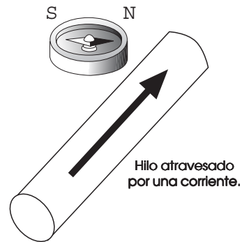
Fig. 9. La corriente eléctrica engendra un campo magnético
