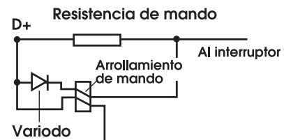
Fig. 59 Regulador de variado (esquema del elemento regulador de tensión)
