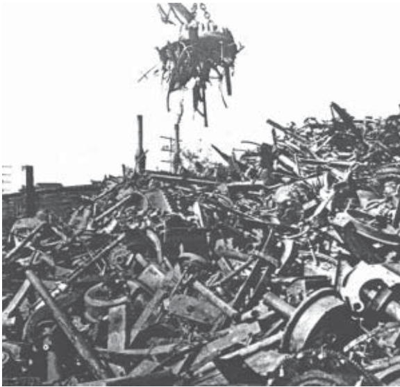
Fig. 23. Electroimán utilizado para manipular chatarra de hierro
